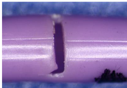
Figura 1: Exemplu de fisură transversală/circumferențială în corpul cateterului
